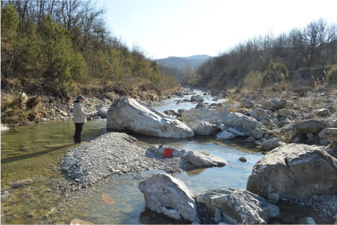
Figura 9. Sito S18, a valle della confluenza con il Rio dell'Oso. Si noti la dimensione dei blocchi. Il masso dietro la barra S18 è utilizzato come ancoraggio per il tubo idrometrico.
